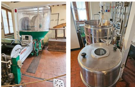
*Mit diesen Geräten wird das wertvolle Vegetationswasser „Aqua mora“ hergestellt, im Edelstahlbehälter aufgefangen und anschließend in kleine Gläschen gefüllt.*
